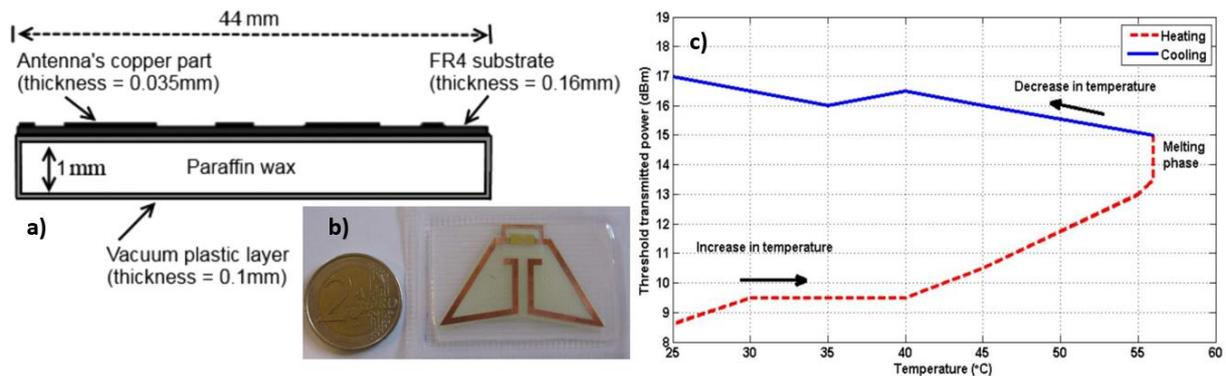
Figure 1-29: Bio-capteur-RFID à détection de seuil : a) vue en coupe du capteur-RFID, b) vue par dessus, c) Effet irréversible du substrat de paraffine : évolution de la puissance minimum d'activation de la puce en fonction de la température [61].
