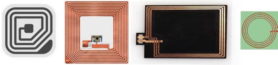
Figure 1-16: Différente forme de tag RFID HF (NFC)
