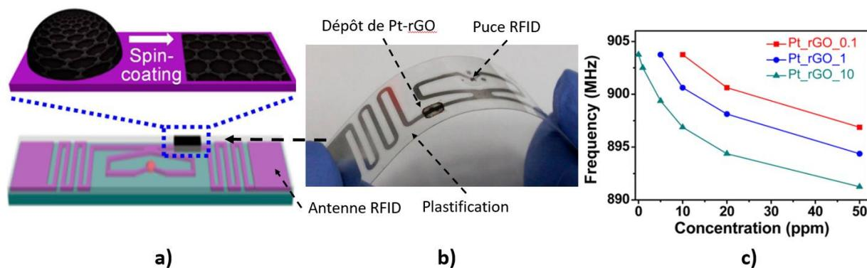
Figure 1-32: Résultats tirés de [48] : a) Diagramme schématique d'une étiquette de capteur d'identification par radiofréquence (RFID) fonctionnalisé par Pt\_rGO. b) Photographies du capteur RFID flexible. c) résultats de mesure du capteurs-RFID en fonction de la concentration d'hydrogène.
