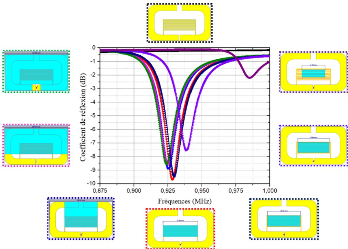
Figure 2-23: Etude paramétrique sur la zone de dépôt
