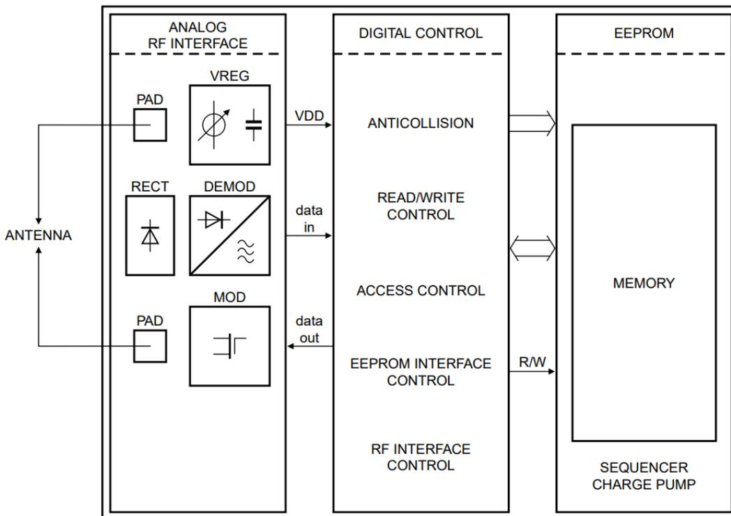
Figure 1-9 : Structure interne d'une puce RFID UHF NXP [10]
