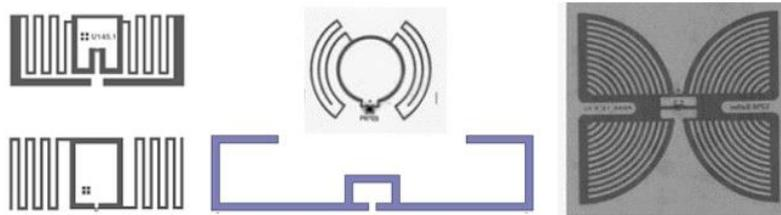
Figure 1-17: Différente forme de tag RFID UHF
