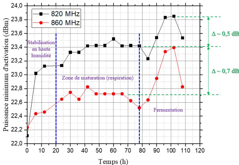
Figure 4-14 : Résultats d'expériences sur la salade jusqu'à détérioration de l'aliment utilisant deux tags, avec et sans dépôt du gluten.
