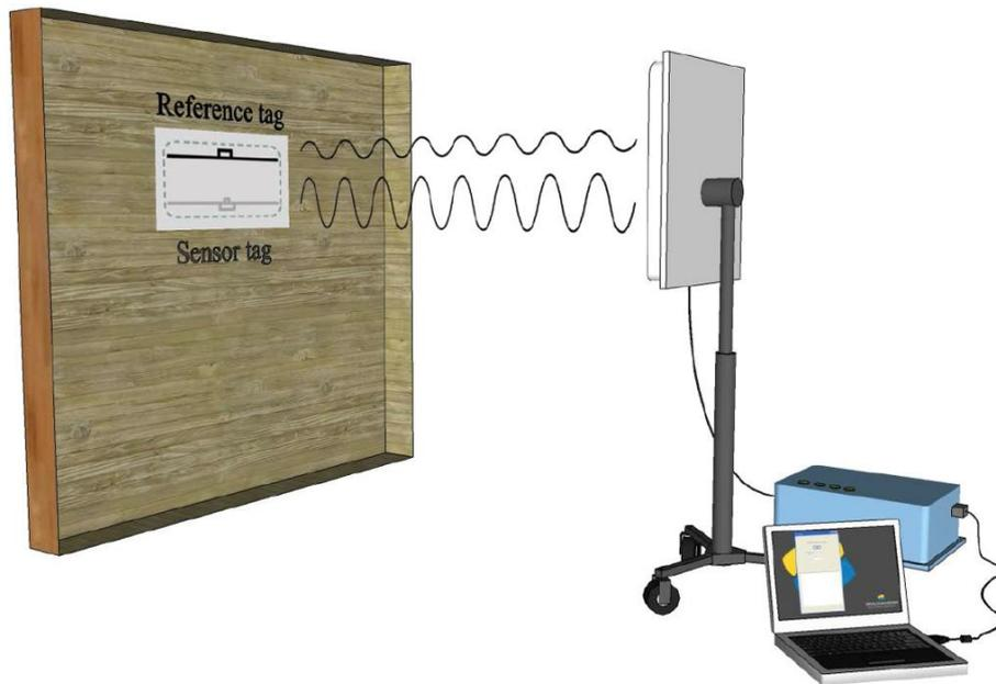
Figure 3-5: Illustration du concept de mesure différentielle [10]
