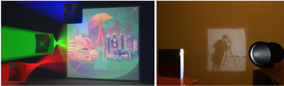
Figure 4 – Exemple simulé et prototype physique obtenus avec notre méthode. À gauche : trois lentilles qui réfractent les trois canaux d’une image couleur avec trois sources collimatées. À droite : miroir qui réfléchit une source collimatée.
