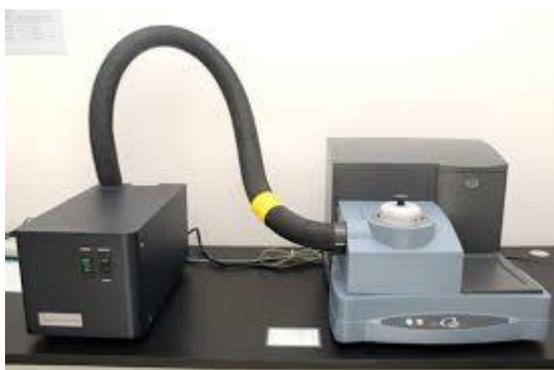
*Figure 17 : DSC Q20 couplé au système de refroidissement RCS 40.*
