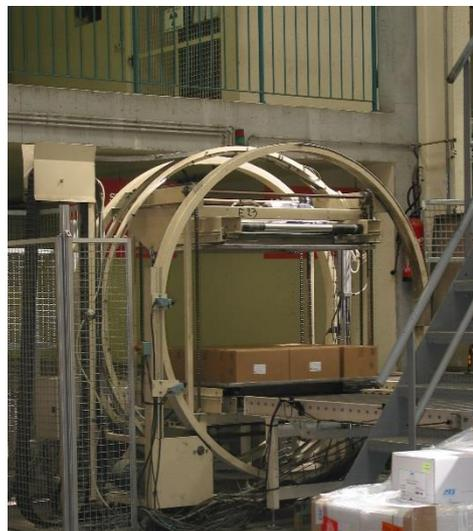
*Figure 13: Système automatique de convoyage utilisé par la société Ionisos à Chaumesnil [203].*
