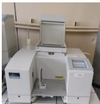
*Figure 15: Spectromètre IRTF (Perkin Elmer 2000)*
