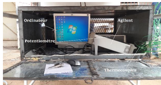
Figure 3. 3 : Dispositif de mesure des températures.
