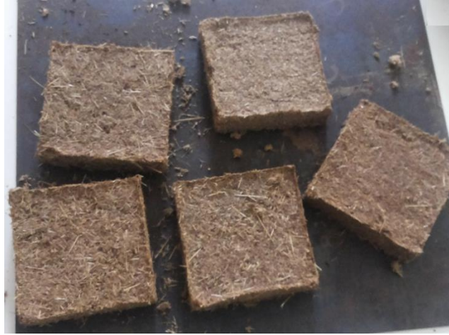
Figure 3. 8: Image des échantillons pour le test thermique.
