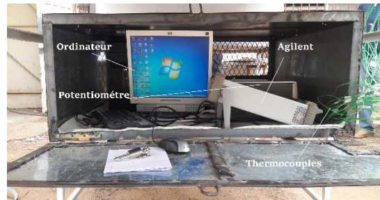
Figure 3.3 : Dispositif de mesure des températures.
