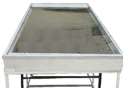
Figure 3. 2 : Photo du capteur solaire thermique double passe à air.
