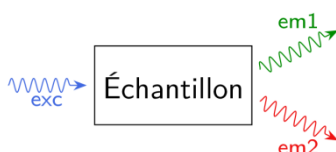
Figure IV.4. : Schéma de fonctionnement de la sonde.
