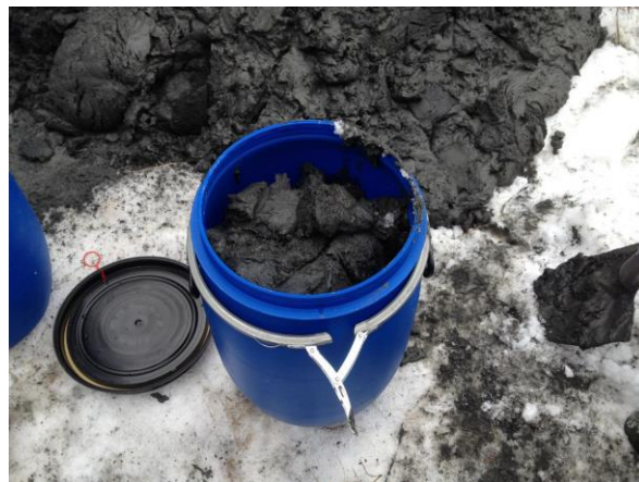
Figure 3.10 : Aspect du sédiment brut et conditionnement en fûts étanches
