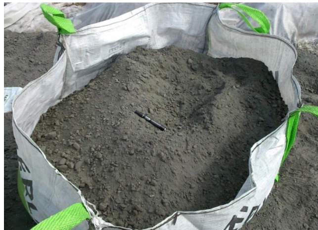
Figure 3.17 : Sédiment CLA déshydraté, criblé à 40 mm et conditionné en big bag
