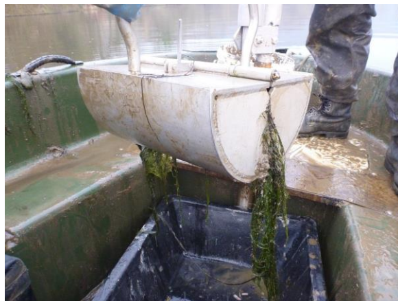
Figure 3.6 : Benne Van Veen fermée contenant des macrophytes lors du dégagement de la zone de prélèvement
