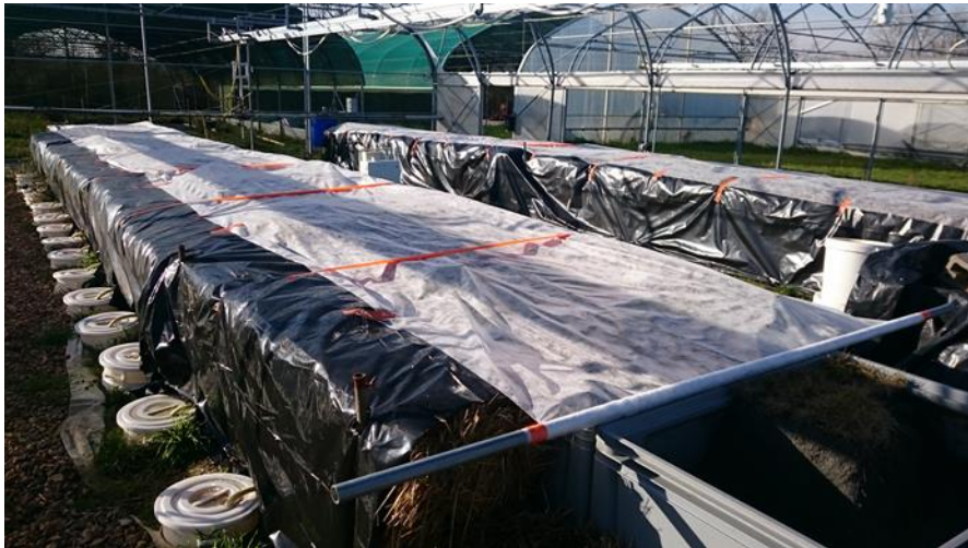
Figure 3.22 : Bacs lysimétriques entourés d'une ceinture de paille (sous une bâche noire) et recouverts d'un voile d'hivernage (6 janvier 2017)
