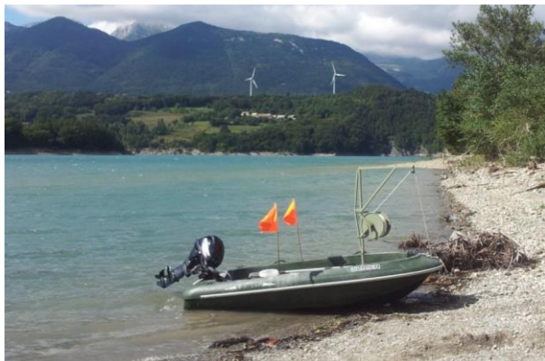
Figure 3.3 : Embarcation équipée d'un treuil et d'une benne Van Veen
