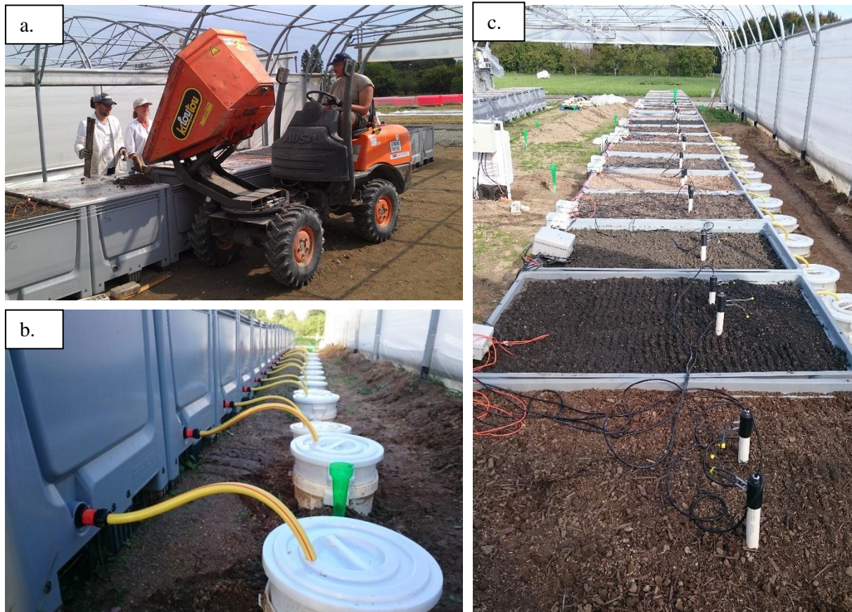
Figure 3.21 : (a.) installation d'un bac, (b.) dispositif de récupération des percolats des bacs instrumentés, (c.) vue de dessus de bacs instrumentés
