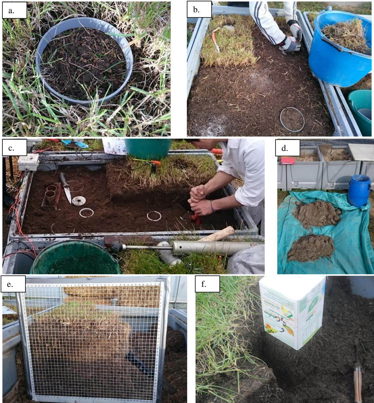
Figure 3.27 : Illustrations de certaines étapes du protocole d'échantillonnage : a. Prélèvement de la biomasse aérienne de ray-grass entre la surface du sol et la hauteur de coupe (8 cm) ; b. décapage du système racinaire superficiel ; c. prélèvements des cylindres de pF et de la biomasse racinaire dans la couche 10-20 cm ; d. dépôt en tas du sol prélevé dans la couche 0-10 cm (haut de la photo) et dans la couche 10-20 cm (bas de la photo) ; e. description du profil racinaire ; f. prélèvement de l'échantillon non perturbé (P) pour l'analyse d'image.
