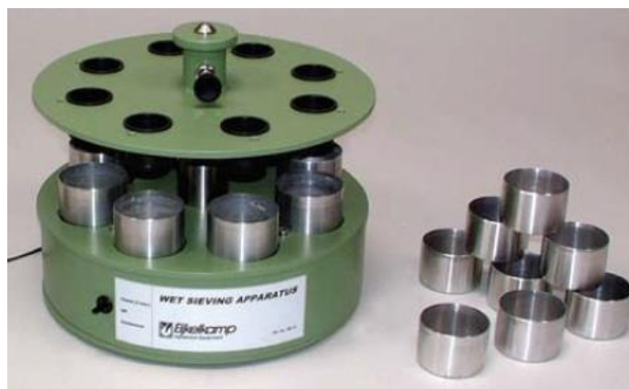
Figure 3.34 : Tamiseuse en voie humide utilisée (marque : Eijkelkamp)
