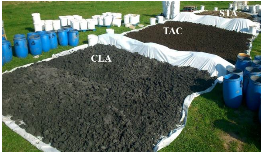
Figure 3.16 : Zones de séchage des sédiments CLA, TAC et STA
