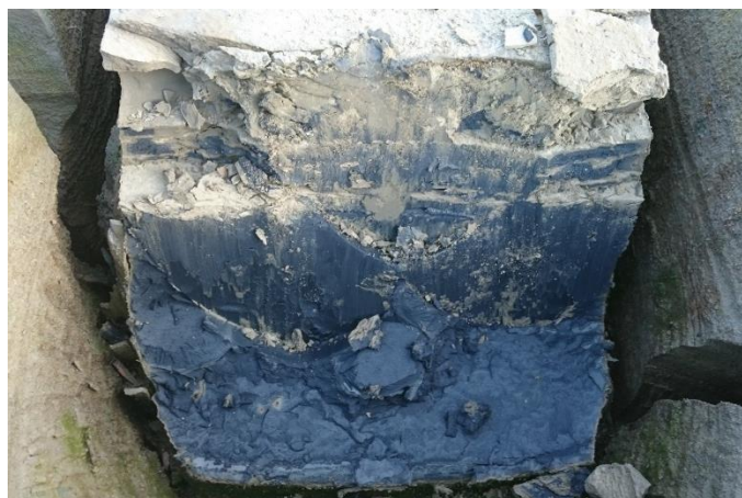
Figure 3.12 : Aspect visuel du sédiment RAN (oxydé : brun et réduit : noir)
