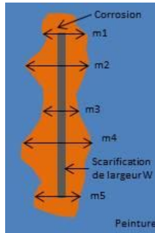
Figure 3-96 : Principe de la mesure du degré de corrosion suivant la norme ISO 4628-8, avec m1, m2, m3, m4 et m5 des mesures ponctuelles réalisées aléatoirement au niveau du défaut.
