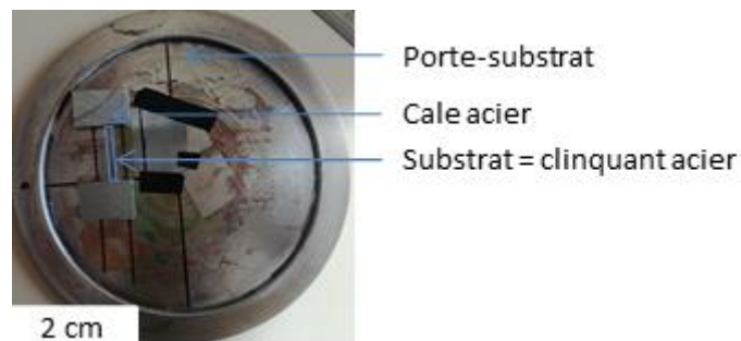
Figure 2-64 : Photo du montage utilisé lors du dépôt PVD HiPIMS sur clinquant acier de 30\ \mu\text{m} d'épaisseur.
