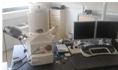
Figure a7-147 : Photo du MEB utilisé (Zeiss EVO 40) et de l'interface de contrôle associé.
