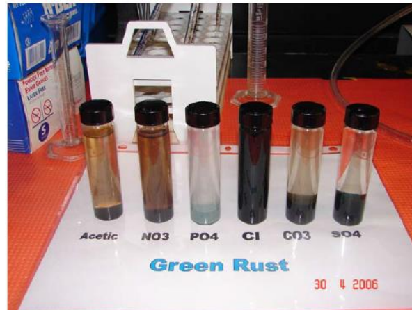
Figure a17-162 : RV formée par électrocoagulation avec différents acides. [326]
