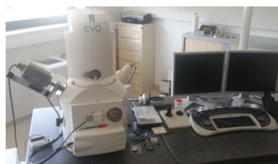
Figure a7-147 : Photo du MEB utilisé (Zeiss EVO 40) et de l'interface de contrôle associée.
