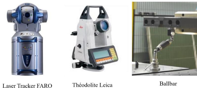
Figure 2-4 : Différents capteurs de mesure externe pour l'identification géométrique des robots
