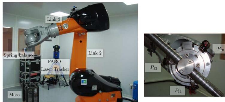
Figure 1-12 : Mesure expérimentale de la rigidité d'un robot industriel (Dumas et al., 2011)
