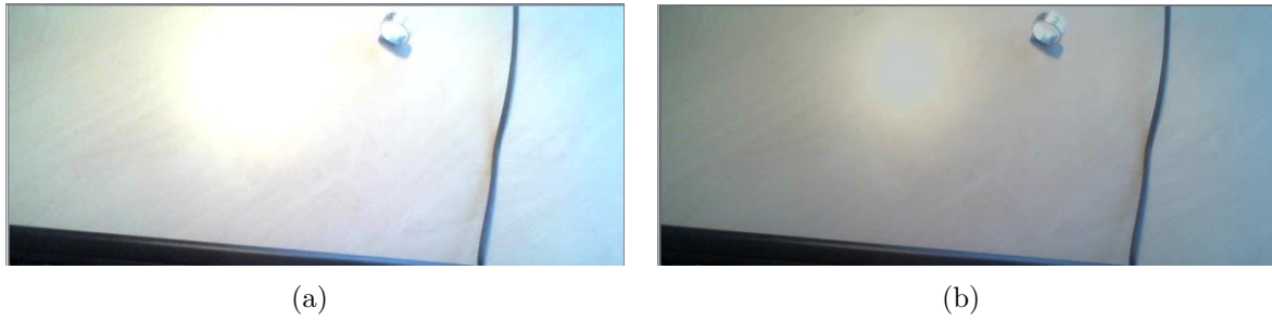
FIGURE A.1 – Résultat de notre égalisation de contraste : (a) présente le cas surexposé, difficilement exploitable en l'état. (b) montre l'image (a) après notre égalisation de contraste
