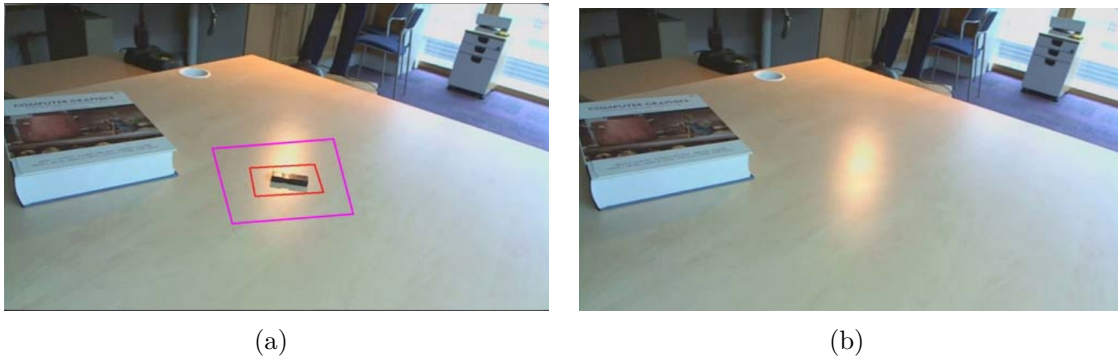
FIGURE 7.9 – Exemple de prise en compte des spécularités dans une application de réalité diminuée. Dans cette figure, une clé USB est supprimée d’une table en bois en présence d’une spécularité. Il est important ici de synthétiser la spécularité lorsqu’elle se déplace sur la zone où la clé USB a été supprimée pour assurer une cohérence visuelle. Images extraites de Said et al. (2017) .
