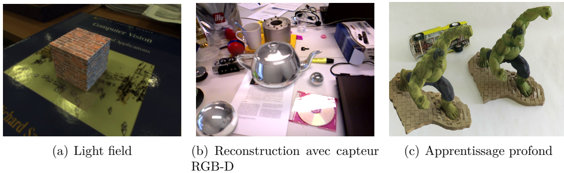
FIGURE 3.2 – Trois illustrations de méthodes d’illumination globale. Dans (a), la méthode de Jachnik et al. (2012) permet d’ajouter un objet en réalité augmentée (cube en brique) dans des conditions d’illumination réalistes en reconstruisant un light field . Dans (b), à l’aide d’une caméra RGB-D, une reconstruction de la géométrie de la scène et de l’illumination sous forme d’un light field est réalisée. Dans (c), à partir d’une image RGB et d’un processus d’apprentissage profond des harmoniques sphériques de l’objet, un rendu réaliste est réalisé sur la figurine. Cependant, ces trois méthodes sont limitées à la zone d’initialisation/apprentissage et ne sont pas assez flexibles dans un environnement plus dynamique (grands déplacements de caméra, lumières qui s’allument ou s’éteignent).
