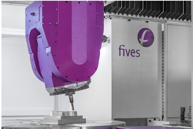
FIGURE I.13: Broche à fort couple de la machine Forest-Liné Flexiax V [Fives, 2018]
