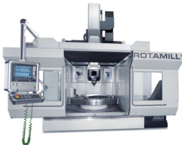
FIGURE II.2: Centre d'usinage par fraisage tournage rectification 6 axes EDEL ROTAMILL [EMC-FRANCE, 2018]
