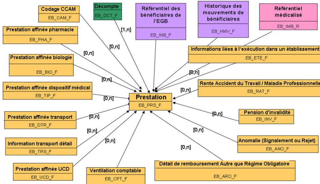
FIGURE 2.1 – Architecture complexe de l'EGB (équivalente au SNIIRAM) en étoile. Une table principale des prestations est reliée à plusieurs tables par type de sources de recueil.
