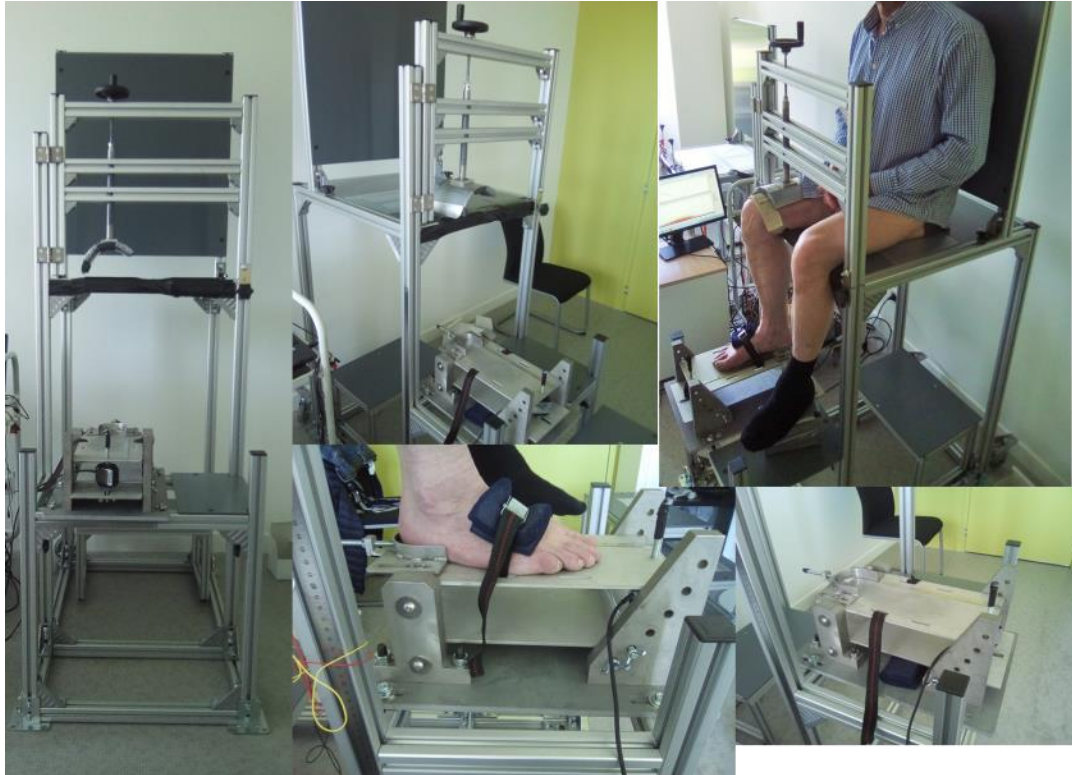
Figure 34 : Ergomètre cheville en construction, puis en phase de test avec sujet installé
