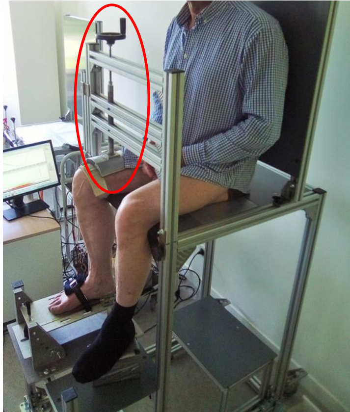
Figure 41 : Positionnement du sujet sur l'ergomètre cheville et son système de maintien lors de la contraction
