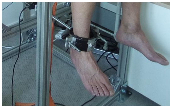
Figure 42 : Positionnement de la cheville dans l'attache-cheville sur l'ergomètre genou
