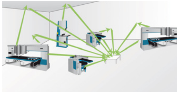
FIGURE 3.10 – Propagation du bruit dans un atelier.
