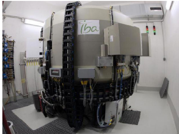
FIGURE 1.5 – Production de radioisotopes par un cyclotron, inventé au début des années 1930 par le physicien américain Ernest Lawrence ( http://www.memoireonline.com/11/11/4954/Dosimetrie-des-photons-de-haute-energie.html )
