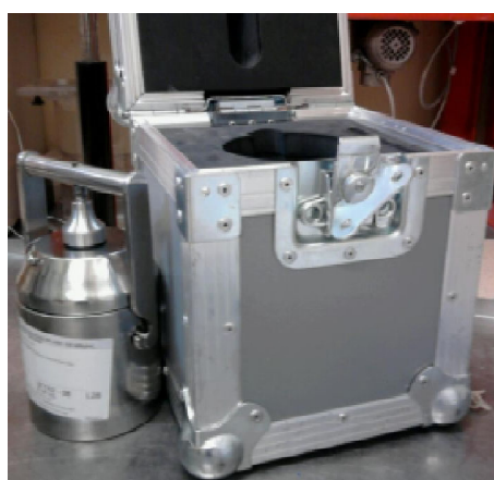
FIGURE 1.7 – Exemple de boîte blindée utilisée sur le site d'imagerie médicale de Brest pour le transport du ^{18}\text{F} – FDG
