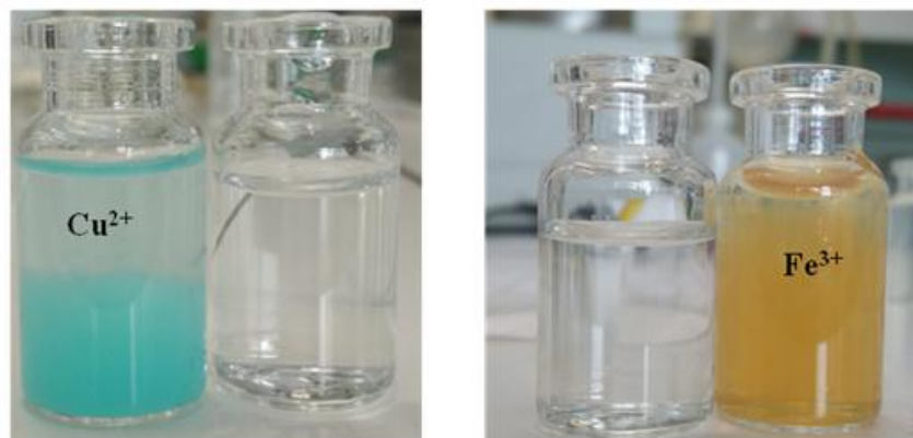
Figure IV.13. Formation d'un complexe entre \beta -CD/PMDA et les ions \text{Cu}^{2+} et \text{Fe}^{3+} .
