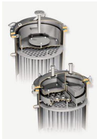
Figure 5 : Représentation de la zone d'alimentation du liquide en tête de faisceau
