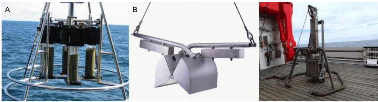
Figure 2.10. Systèmes de prélèvements de MP dans les sédiments marins. A) Carottier multi-tube . B) Benne de type Van Veen . C) Carottier boîte ( Brandt et al., 2016 ).
