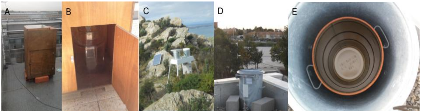
Figure 2.5. Collecteurs de dépôt atmosphérique. A-B) système avec un récipient en verre surmonté d'un entonnoir, utilisé sur un toit de Paris ( Dris et al., 2016 ). C) échantillonneur humide et sec (MTX®). D-E) collecteur simple, utilisé sur le toit du laboratoire CEFREM à Perpignan ( Chap. 4 ; Constant ©).
