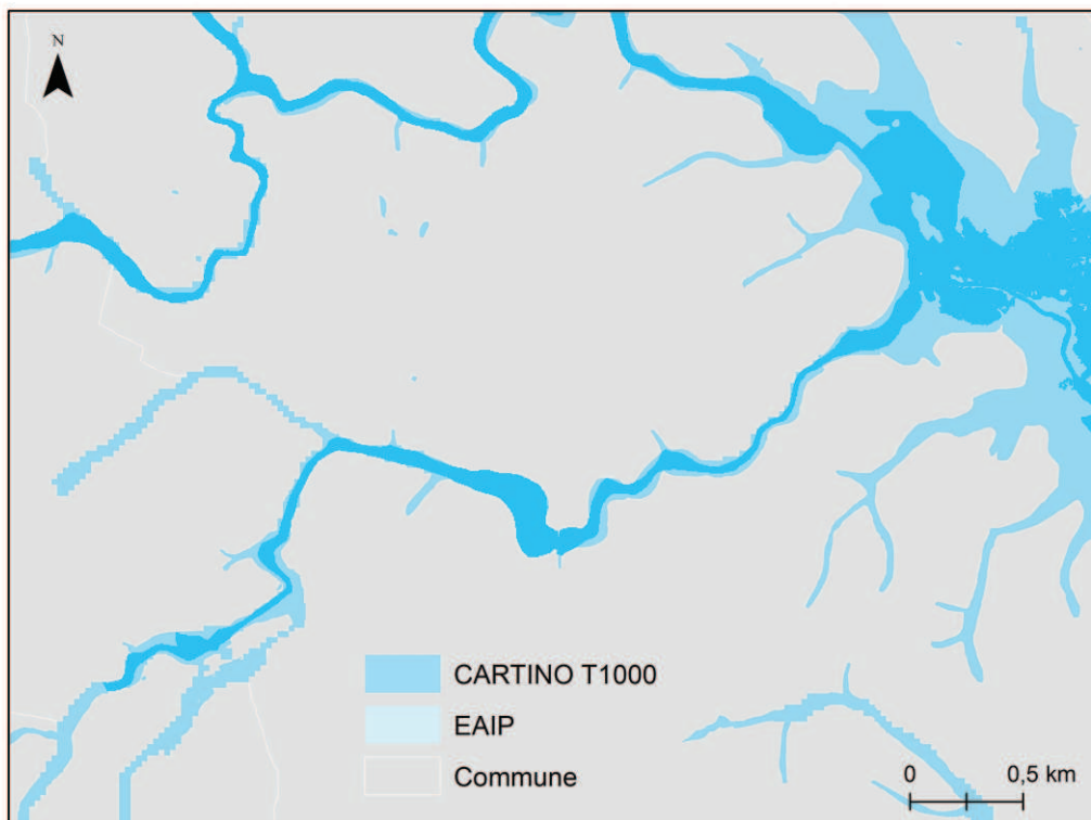
Figure 3.10: Comparaison de l'emprise CARTINO pour T1000 et de l'EAIP pour la Brague (06)
