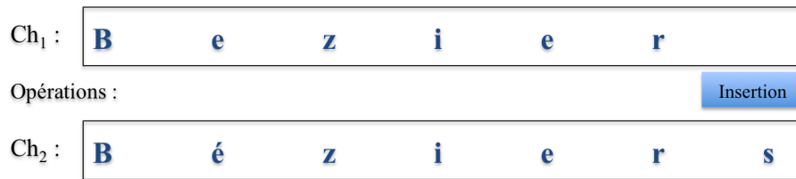
FIGURE 3.3 – Distance d’édition Levenshtein (E) pour les ESA « Bezier » et « Béziers » en utilisant la désaccentuation.
