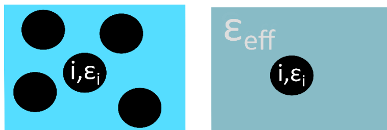
Figure 48 Calcul de la polarisation de l'inclusion i : situation réelle (gauche) et situation utilisée dans le calcul de Bruggeman (droite).
