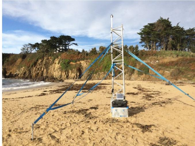
FIGURE 2.12 – Déploiement du LiDaR profileur lors de la campagne DYNATREZ 2.
