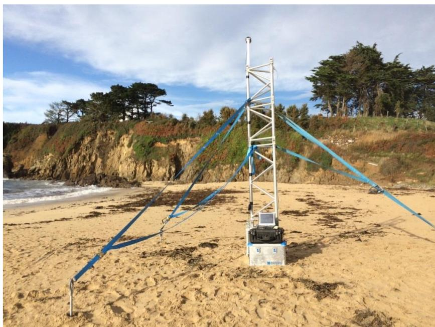
Figure 12 : Photographie de l'installation du LIDAR profileur sur la plage.
