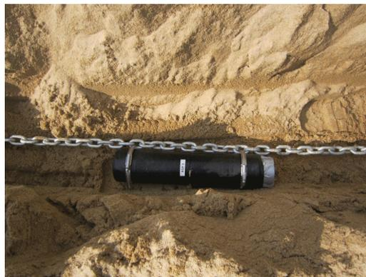
FIGURE 2.14 – Exemple du déploiement d'un capteur de pression sur la plage. Le capteur est attaché le long d'une chaîne grâce à des colliers en métal. Le maintien de la chaîne sur le site est assuré par des vis à sable.
