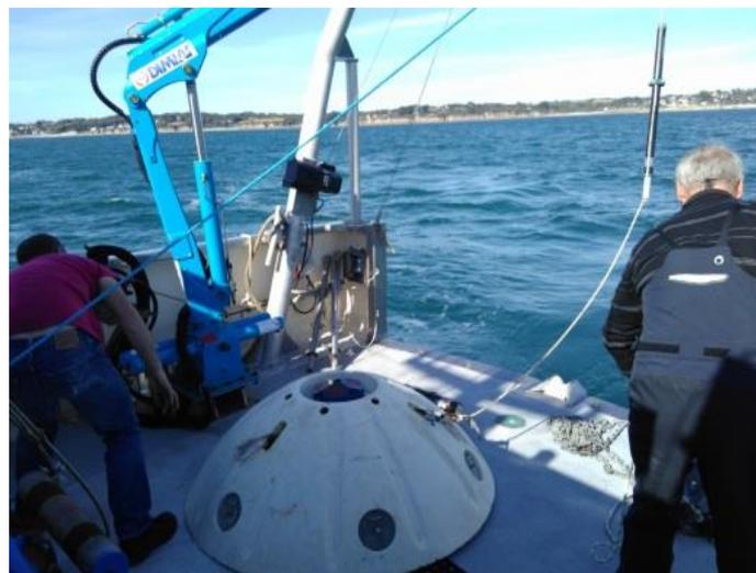
Figure 6 : Déploiement de l'ADCP à bord de l'Albert Lucas.
