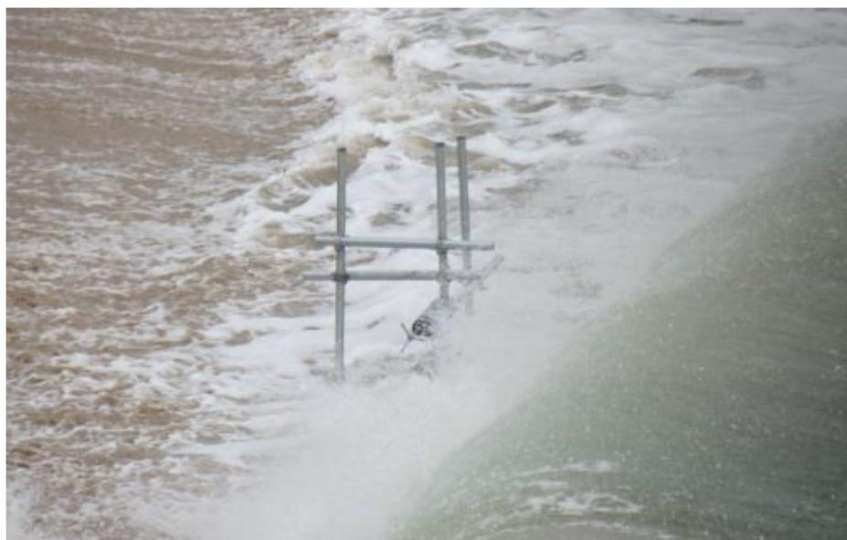
Figure 10 : Module de mesure des courants après déploiement.
