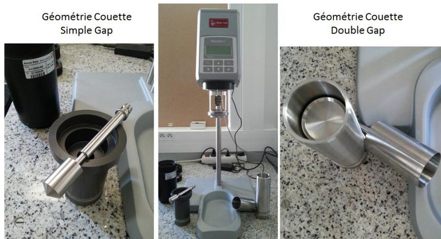
*Figure 1.6. Viscosimètre RhéolabQC (Anton Paar, Autriche) disponible au laboratoire avec sa géométrie Couette simple et double gap.*
