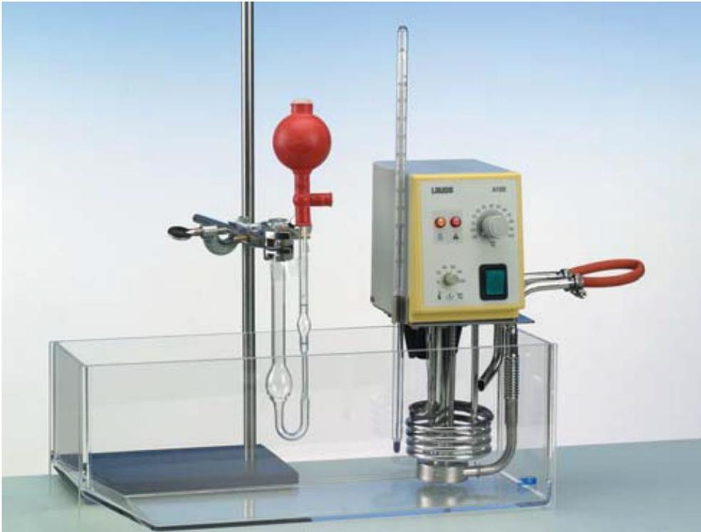
Figure 1.7. Exemple de viscosimètre capillaire (pour des travaux pratiques) avec régulation thermique (phywe.fr).
