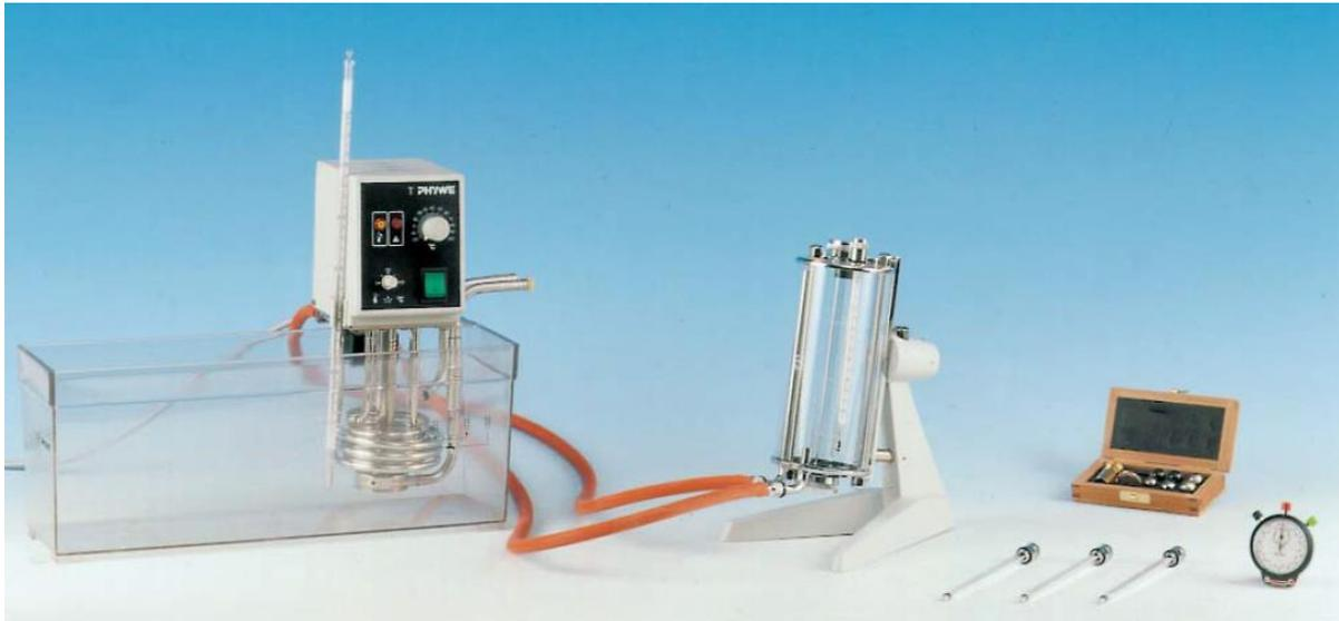
Figure 1.8. Exemple de viscosimètre à chute de bille (dédié aux travaux pratiques) avec régulation thermique (phywe.fr).
