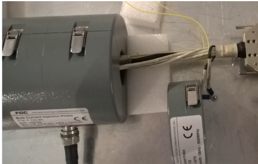
Figure 4.24 – Pince de mesure en dehors du toron
