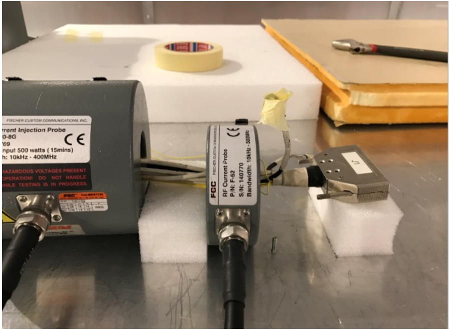
Figure 4.22 – Configuration avec blindage et EST déconnectés
