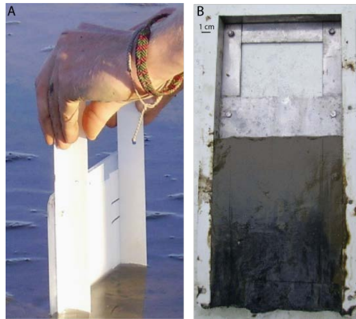
Figure 4 : système de prélèvement pour la tranche de sédiment en vis-à-vis du gel 2D (cliché Edouard Metzger) ; (A) gel 2D lors d'un déploiement sur la vasière de la Loire avec ses rails blancs permettant d'insérer le préleveur de sédiment visible en B ; (B) tranche de sédiment avec son système de prélèvement (cliché Edouard Metzger).
