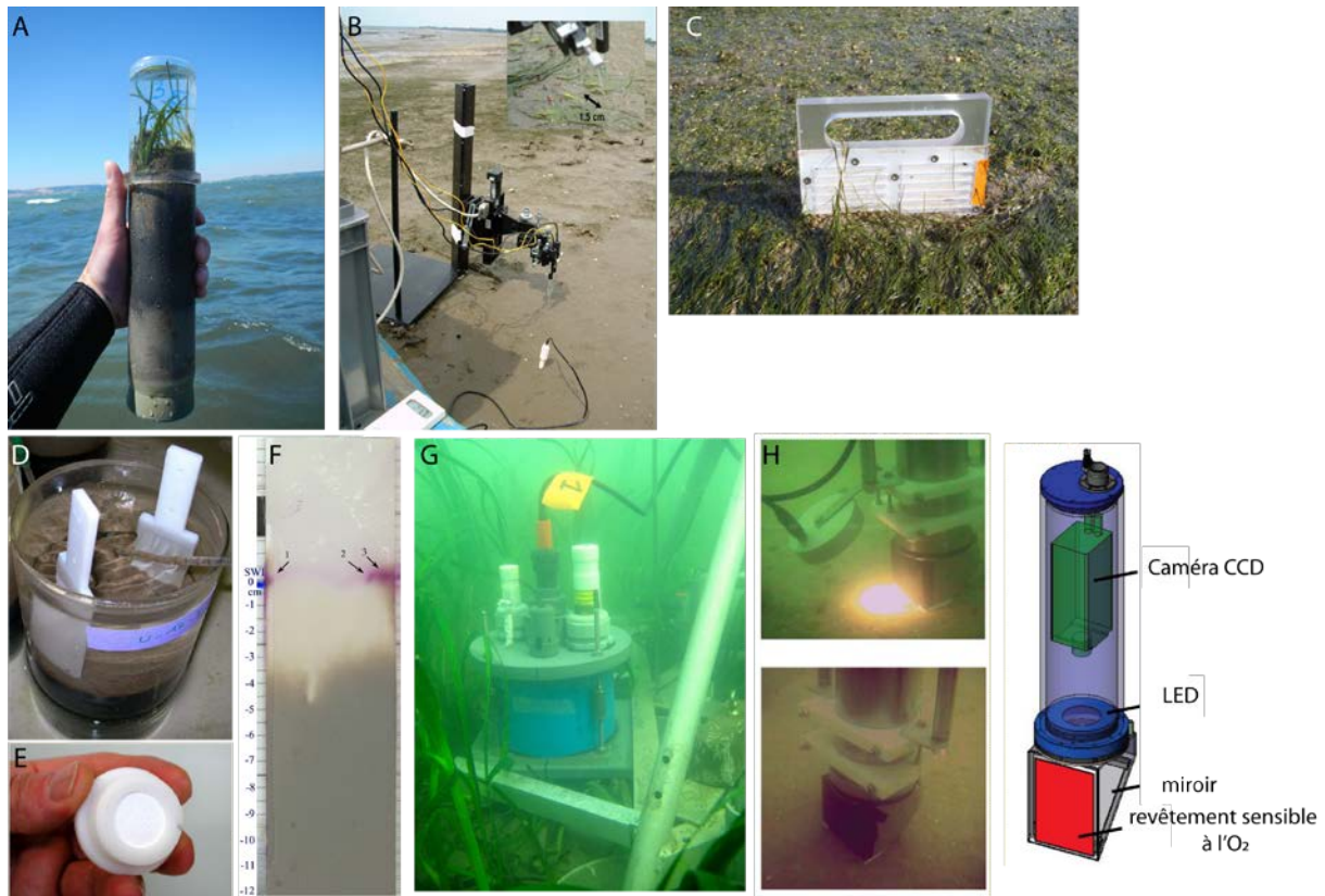
Figure 12 : (A) Carottes de sédiment prélevé à l'Etang de Berre (GIS, S. Rigaud), (B) Microélectrode à oxygène (EPOC, B. Deflandre), (C) Peepers (EPOC, B. Deflandre) ; (D) DET 1D (bioecologie-overblog.com), (E) DGT 1D (mn.uio.no), (F) DET 2D (Jézéquel et al. 2007), (G) Cloches benthiques (EPOC, B. Deflandre), (H) Optode planaire à oxygène avec son schéma explicatif (HGF MPG Group for Deep-Sea Ecology and Technology, J. Fischer).
