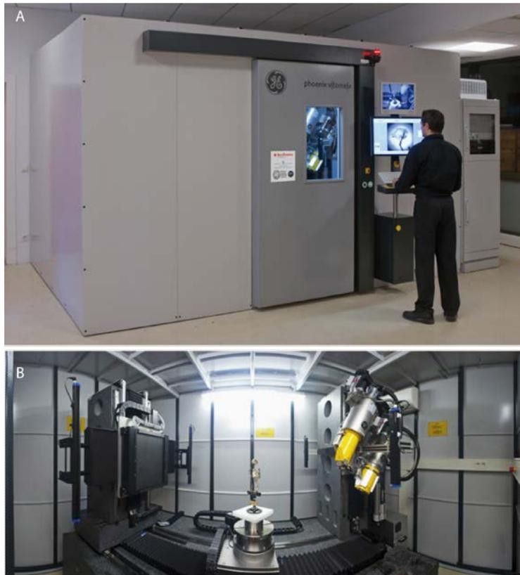
**Figure 10 :** (A) Vue externe de l'équipement et mise en situation de l'opérateur ; (B) vue interne de l'équipement et mise en situation d'un échantillon (source MNHN-CNRS).
