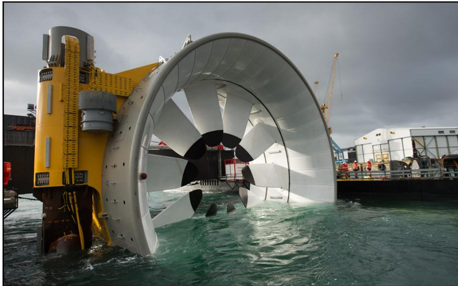
Figure 1.6 : Hydrolienne carénée à flux axial OpenHydro [1].
