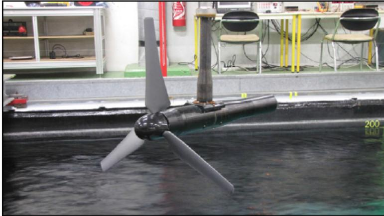
Figure 4.1 : Hydrolienne générique utilisée pour les essais d'Ifremer, Mycek *et al.* (2014) [74].
