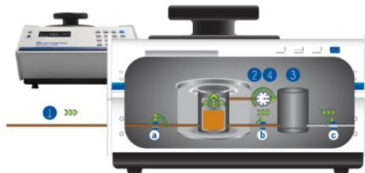
Figure III-11. Pycnomètre à hélium et schématisation des étapes de mesures [MIC18]
