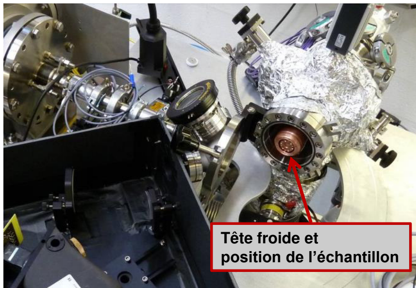
Figure 2-7- photo de la tête froide. Le dispositif entier pivote pour donner accès à l'échantillon. Photo E. Gardés, CIMAP
