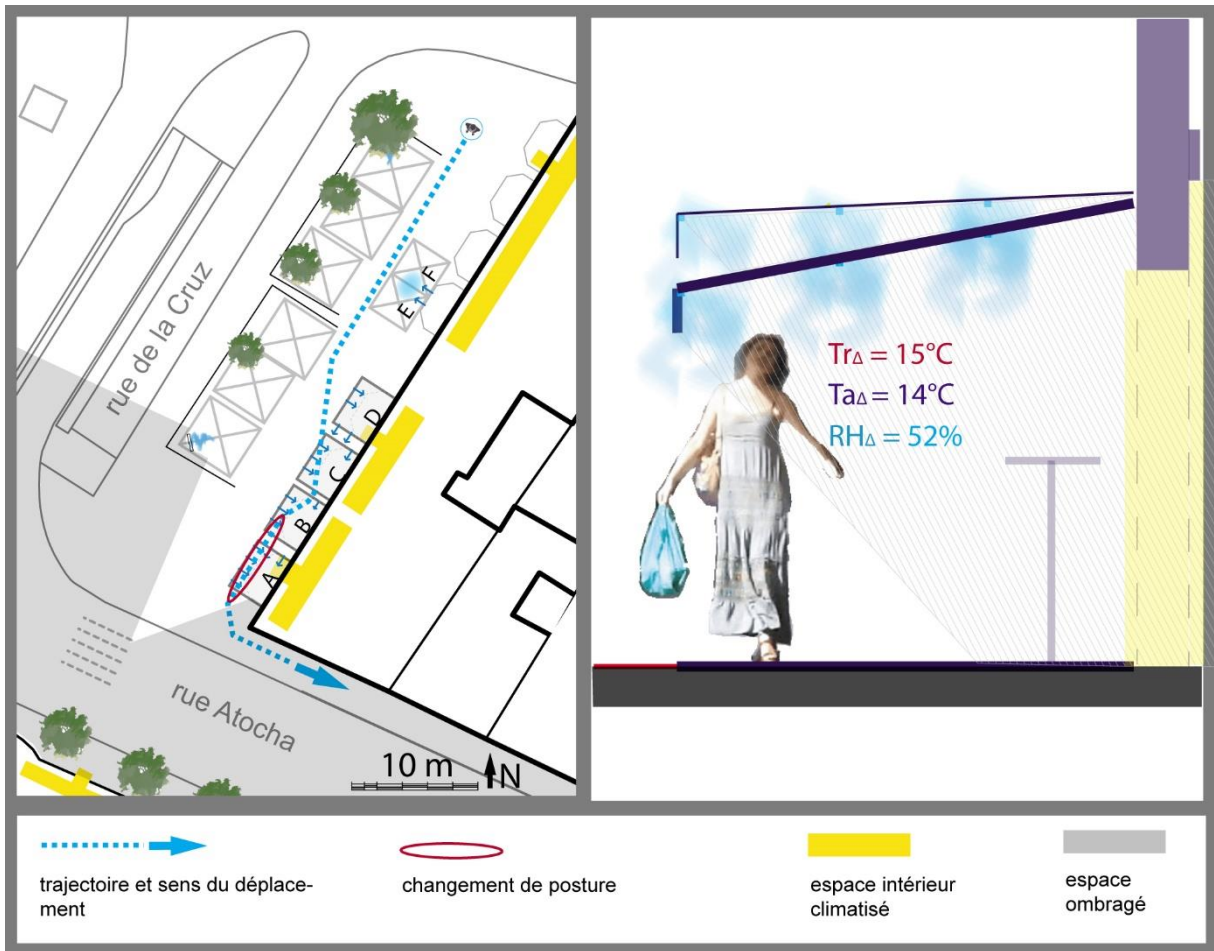
Figure 80 Illustration du passant qui se laisse emporter par les nuages d'eau pulvérisée. A gauche : Modification de la trajectoire en deux étapes. 1) vers la rue Atocha (AT1) et vers l'ombre projetée par les stores bannes et 2) vers la bordure des stores bannes suite au déclenchement des brumisateurs. A droite : Coupe schématique - posture adoptée le temps de traversée de la brume avec les valeurs de différentiel des conditions climatiques pour le point référentiel dans l'espace exposé au soleil (en rouge Tr_{\Delta} – température de rayonnement, en bleu Ta_{\Delta} – température de l'air, et en bleu clair RH_{\Delta} – l'humidité relative). Contrairement aux masques solaires assurés par les immeubles, les ombres projetées par les parasols et les stores bannes représentées sur le plan ne recouvrent qu'une partie du corps, représentée sur la coupe. Le 18/08/2016 vers 16h45.
