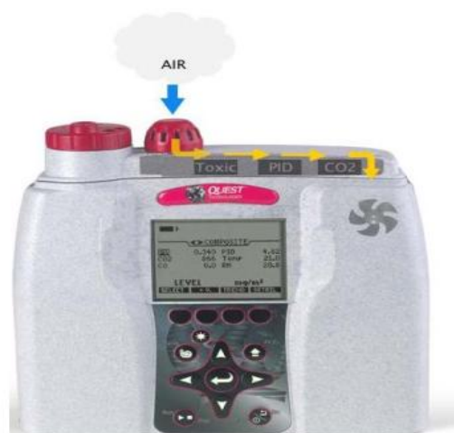
Figure 24 : Capteurs de gaz de l'EVM-7
