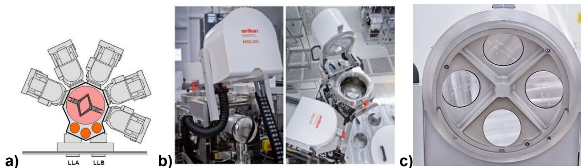
Figure 2.6 : (a) Représentation schématique de l'équipement CLN200. (b) Visualisation du module de co-pulvérisation avec en (c) une photo des quatre emplacements que peuvent occuper les cibles de pulvérisation.
