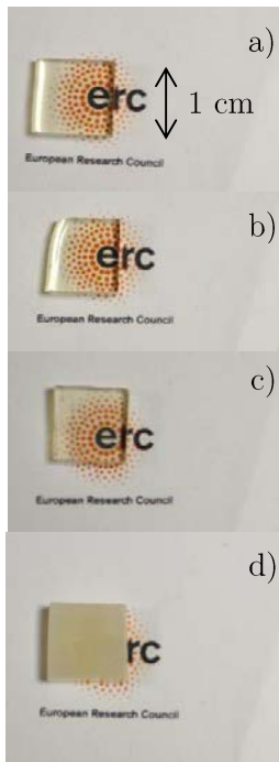
Figure 2-51 : a) Verre de référence. b) Verre nucléé (700 °C – 64 h). c) Verre nucléé (700°C – 64h) et céramisé (825 °C – 30min). d) Verre totalement céramisé (825 °C – 1 semaine). Figure 2-52 : Transmittance du verre B 2 S 3 -A de référence (courbe bleue), du verre nucléé 64 h à 700 °C (B 2 S 3 -A_N, courbe rouge) et nucléé 64 h à 700 °C et cristallisé à 825 °C pendant 30 min (B 2 S 3 -A_N_C, courbe verte). Épaisseur de 3,78 mm.
