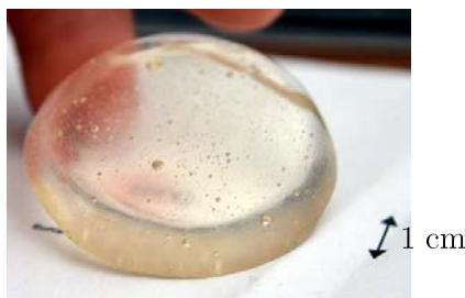
Figure 2-47 : Image des bulles emprisonnées lors de la coulée dans le petit creuset.
