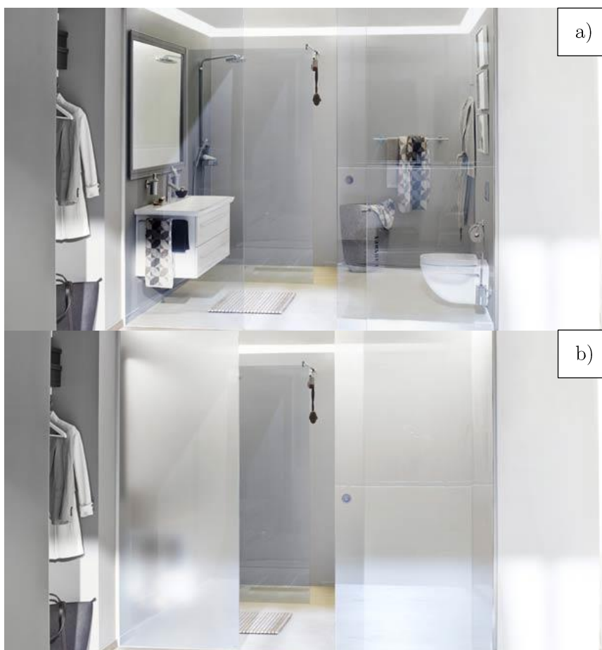
Figure 4-1 : a) Verre transparent. b) Verre après opacification.
