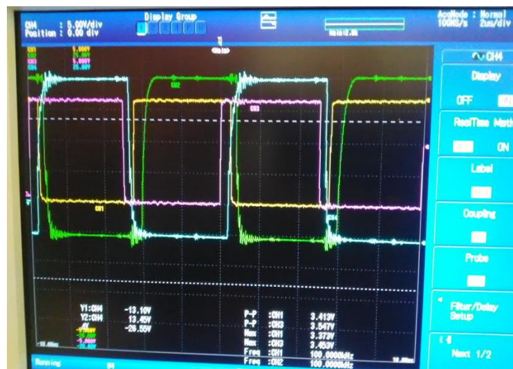
Figure 4. 9 : Signaux de commande PWM à 100kHz de deux grilles du hacheur et leurs signaux de référence issus du GBF.
