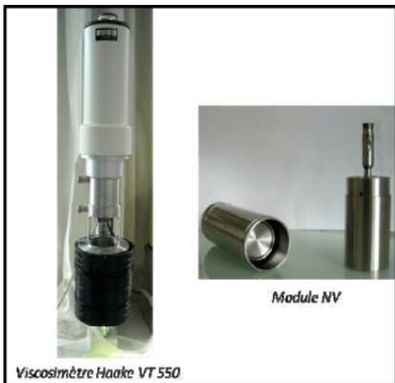
Figure 2.10 : Viscosimètre Haake VT 550 utilisé dans l'étude
