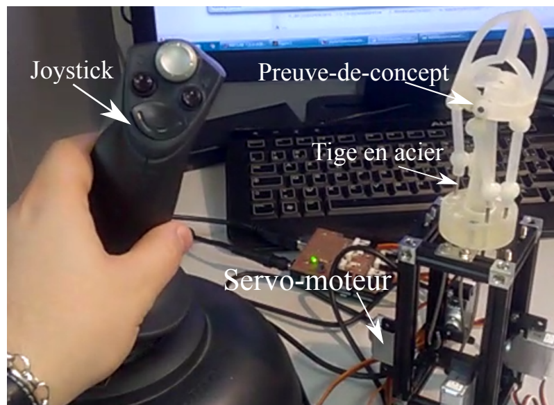
FIGURE 6.11 – Démonstrateur du poignet sphérique à quatre DDL et la manette de commande.
