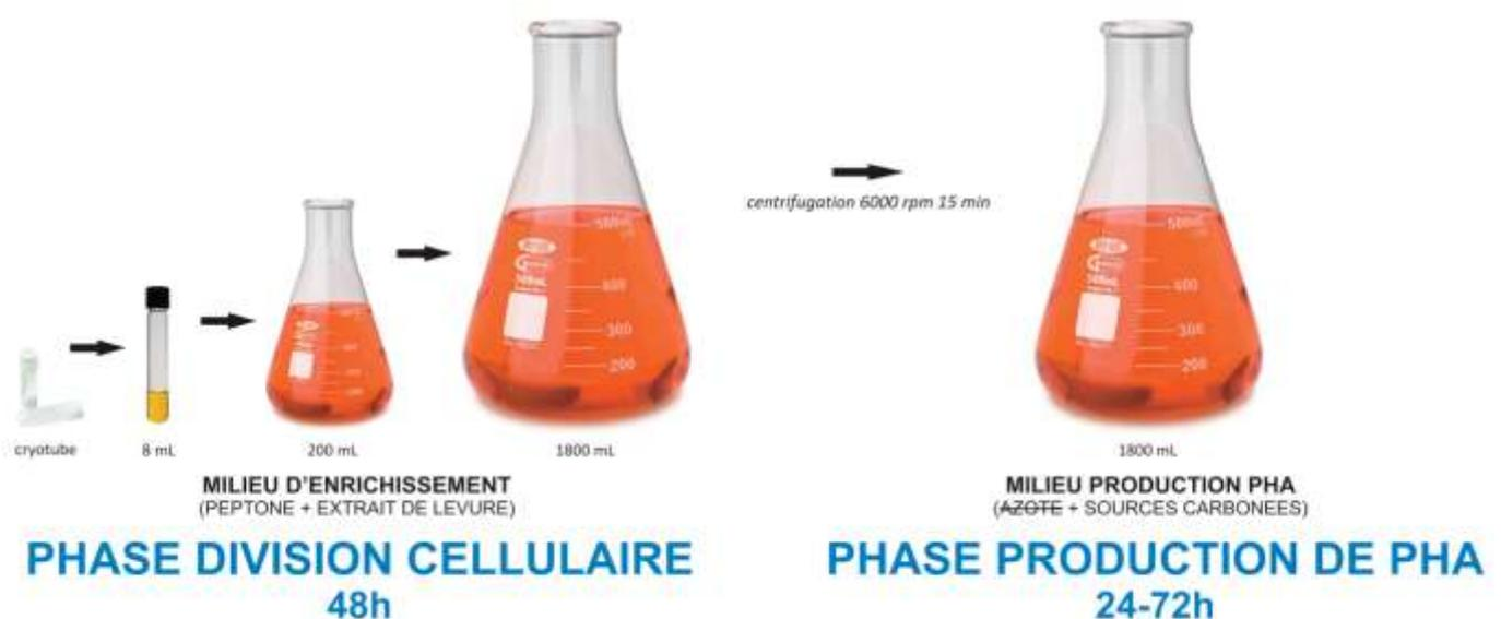
Figure 27. Schéma du procédé de production de PHA en erlenmeyers en deux phases.
