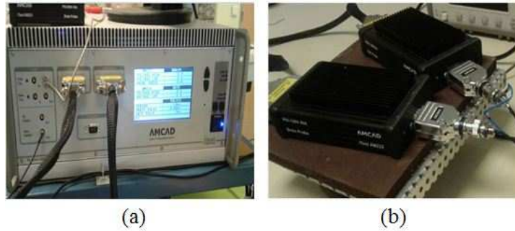
FIGURE II.2: (a) : Face avant du générateur d'impulsions et (b) : Sonde de mesure de la grille et du drain
