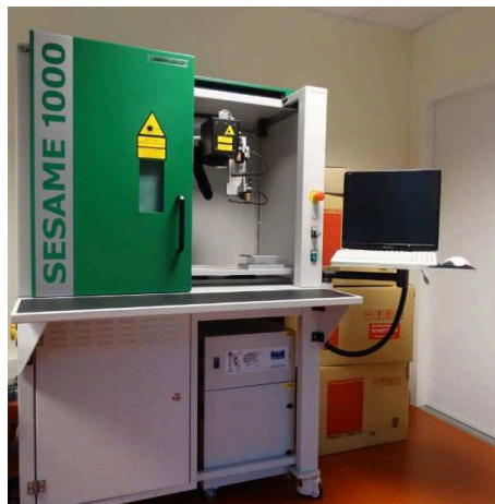
FIGURE IV.2: Équipement d'ablation laser SESAME-1000
