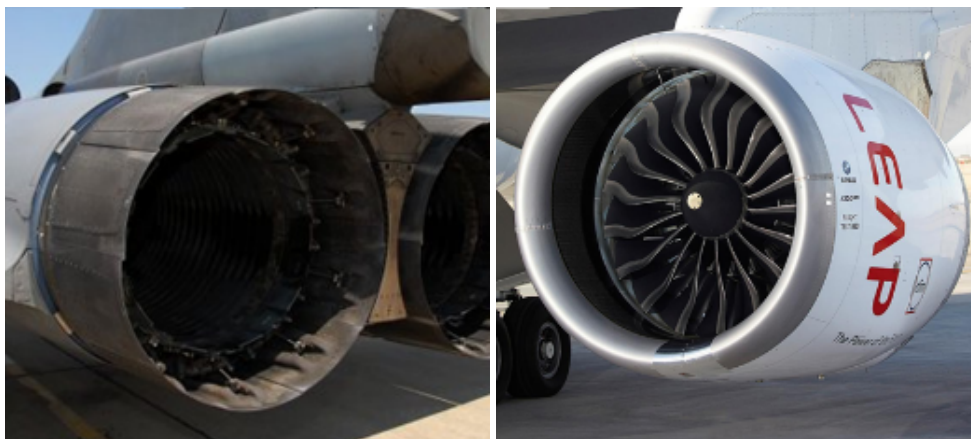
(a) Volets secondaires en \text{C}_f/\text{SiC} de l'arrière corps du M88 (Rafale) (b) Aubes de turbine du moteur LEAP® en \text{SiC}_f/\text{SiC}
