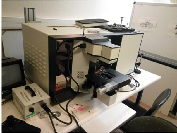
FIGURE II.3.6 – Photographie du spectroscope Raman Horiba-Jobin Yvon Labram HR équipé d'un laser polarisé d'une longueur d'onde de 632 nm
