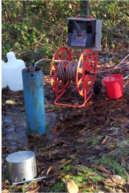
Figure 2.7 Photo d'un piézomètre dans lequel de l'eau souterraine est pompée.
