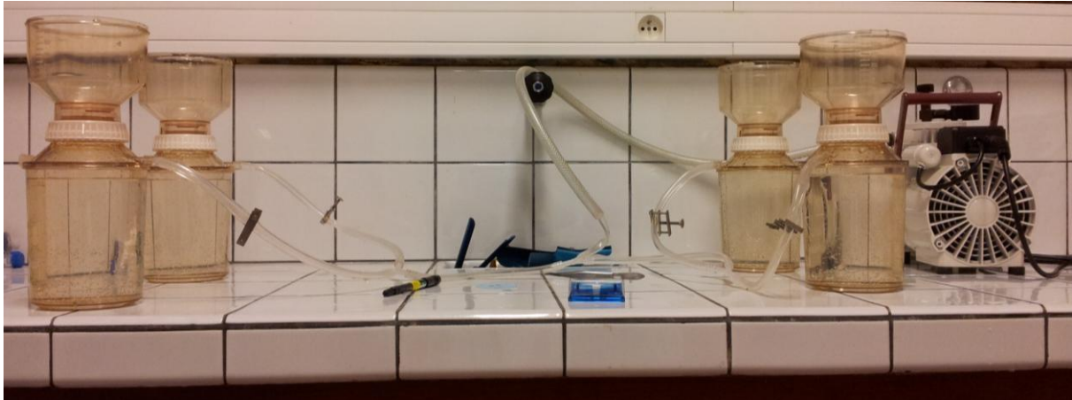
Figure 2.7 Dispositif de filtration de type Büchner. Quatre unités de filtration portant chacune un filtre, sont reliées en parallèle à une pompe à vide qui crée le vide dans le compartiment inférieur de chaque unité. Le filtre est placé sur une grille placée entre les compartiments supérieur et inférieur de l'unité, et l'eau s'écoule à travers le filtre du compartiment supérieur vers le compartiment inférieur grâce à la différence de pression entre les deux compartiments.
