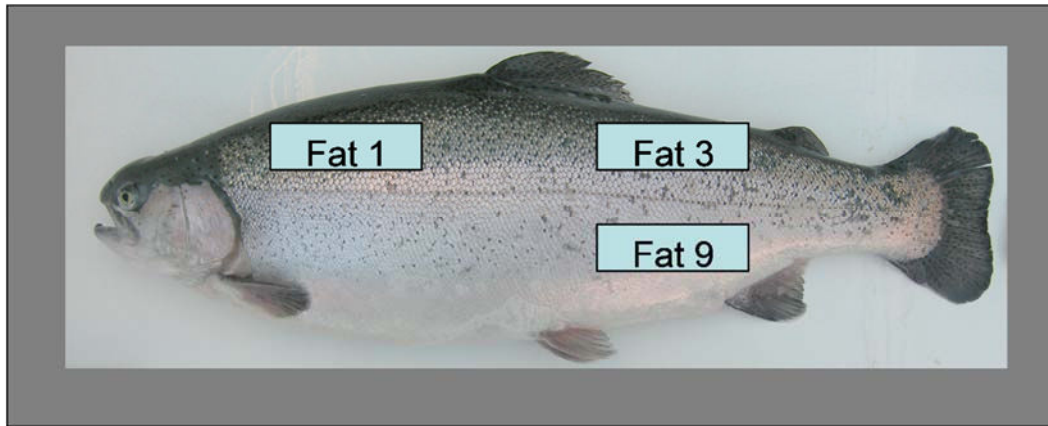
Figure 21 : Positions de la sonde du Fat Meter pour la caractérisation de la teneur en lipides du filet par micro-ondes (2 GHz) sur animal vivant (Lot « Sélectionné » semaine 12-2006, (Fat 1 et Fat 3)) ou sur animal abattu (Lots « Sélectionné » semaine 14-2006 (Fat 1 et Fat 3) et « Témoin » semaine 17-2006, (Fat 1, Fat 3 et Fat 9)).
