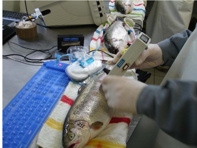
Figure 24 : Estimation de la teneur en lipides des filets avec le Torry Fish Fat Meter (ici en position Fat 9).
