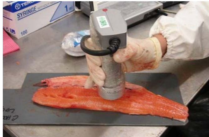
Figure 25 : Mesure des paramètres de coloration du filet avec le chromamètre Minolta CR200.
