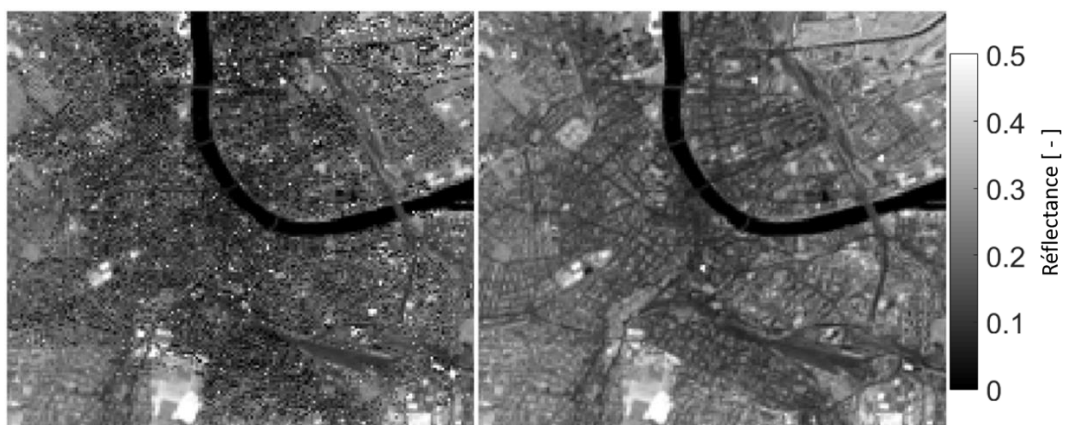
Figure 4.10 : Images de réflectance DART (gauche) et Landsat-8 (droite) du 30.08.2015, à 30m de résolution. Bande B5 : 864.6nm. L'image Landsat-8 est corrigée des effets atmosphériques.
