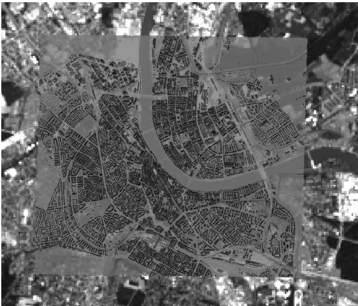
Figure 3.9 : Image DART ( \Delta r=2.5m ) superposée à une image Landsat-8 ( \Delta r=30m ) de la ville de Bâle.
