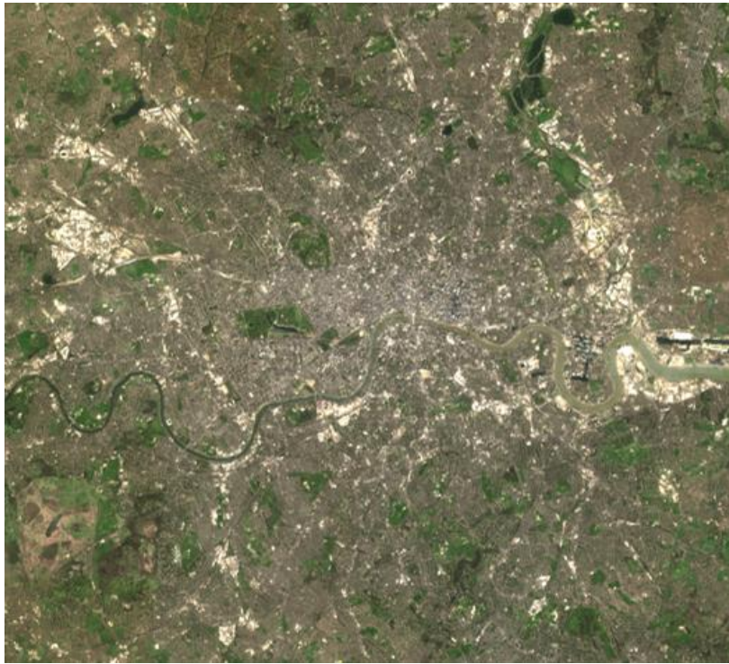
Figure 2.16 : Composition colorée RGB utilisant les bandes 2, 3, et 4 du capteur LS8 OLI, corrigées des effets atmosphériques, pour la ville de Londres (Angleterre), le 9 Avril 2015
