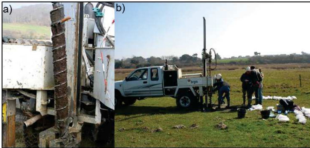
Figure 33. a) Tarière, b) Vis tarière motorisée de type 4X4 du BRGM, photos A. Hénaff
