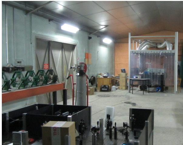
FIGURE 1.21 – Photographie de la chambre de tir à l'ISL dans laquelle a été installé le laser TRIDENT (à l'arrière plan, dans l'espace climatisé). Le système de production et de détection THz est visible au premier plan. Il est situé à une distance d'environ 15 m du laser.
