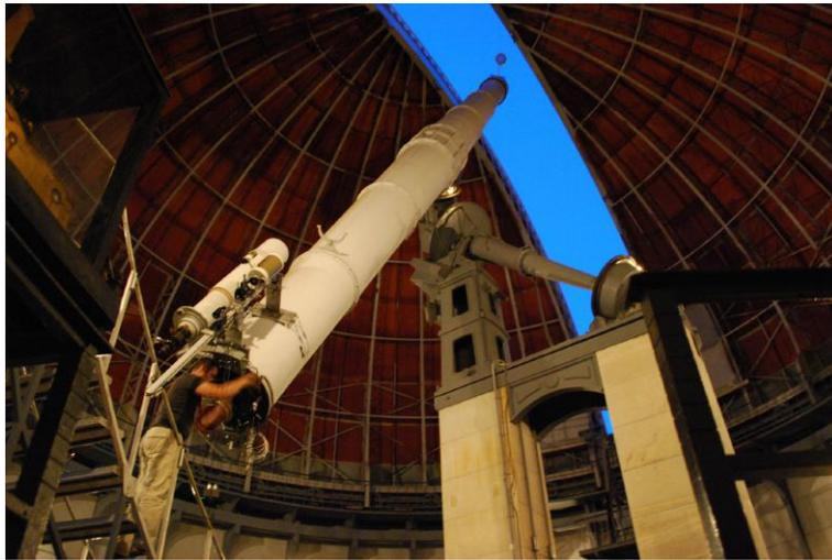
FIGURE 3.6 – Photo du prototype de Génération II monté sur la grande lunette de Nice. On peut distinguer la grille de Fresnel au dessus de l'ouverture de la lunette, le reste de l'imageur de Fresnel le long du côté droit du viseur, et J.P. Rivet l'un des chercheurs ayant participé à la conception de ce prototype.
