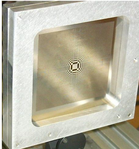
FIGURE 3.1 – Première grille de Fresnel pour le prototype de Génération I. Elle possédait alors une géométrie purement orthogonale, avec 58 anneaux de Fresnel. Elle était optimisée pour fonctionner à 600 nm avec une distance focale de 23 m.
