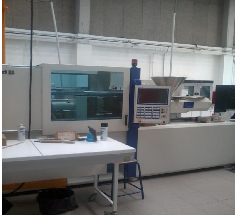
Figure II.7 : Presse à injection plastique de type Battenfeld HM 80-210 S Unilog B6.
