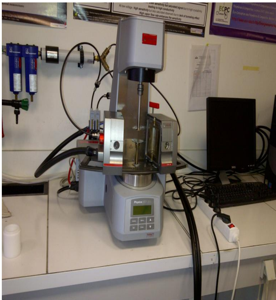
Figure II.10 : Image d'un rhéomètre de type Anton Paar MCR 301.
