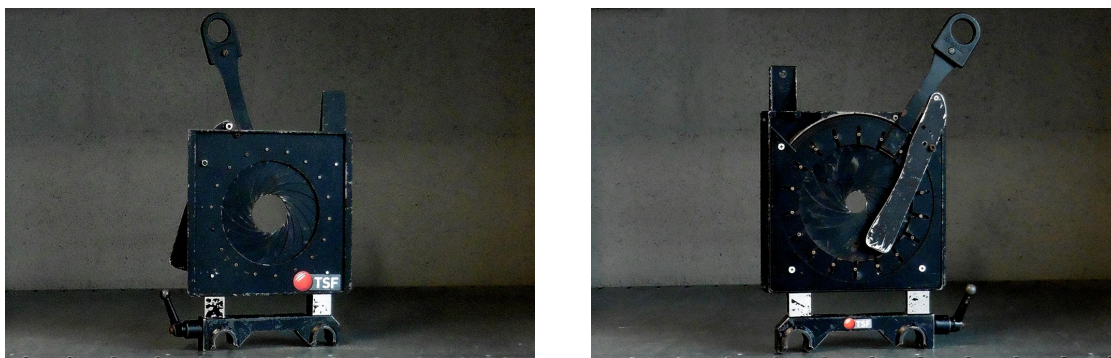
Fig. 5.21 Iris de TSF caméra : à gauche, face avant ; à droite, face arrière, avec sa lamelle de fermeture au noir © Jean-Noël Ferragut (Source : AFC, URL : https://www.afcinema.com/L-iris-de-Francois-Jacques-Ossang.html?lang=fr )
