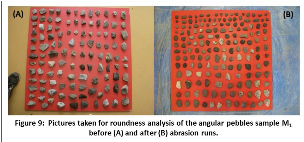
Figure 74. Photographies de l'échantillon M1 (anguleux) avant (A) et après (B) les 8 expérimentations d'abrasion.
